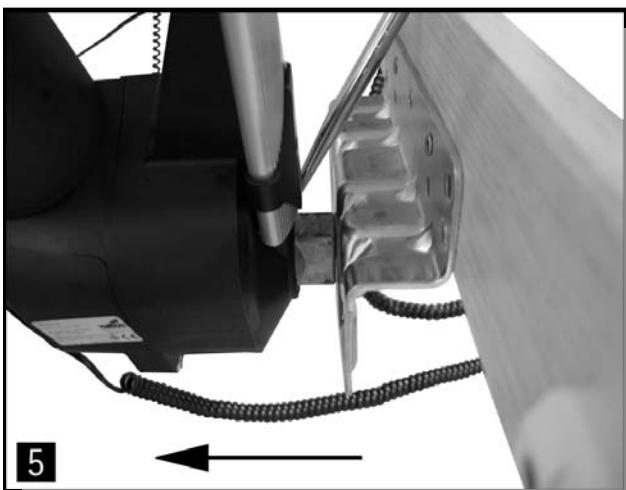
5. Mit dem Werkzeug den Vierkant des Antriebs aus dem Stützwinkel herausschieben
