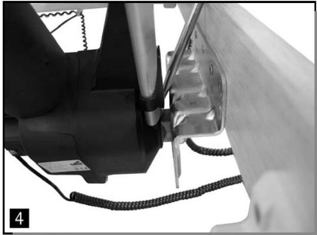
4. Das Werkzeug zwischen Antrieb und Stützwinkel sicher ansetzen
