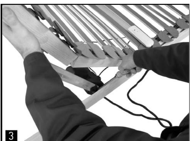
3. Geeignetes Werkzeug zwischen Antrieb und Stützwinkel ansetzen
