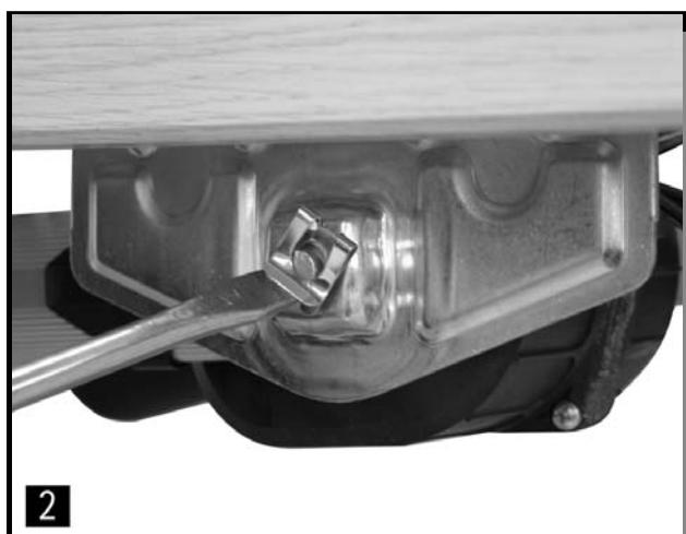
2. Mit einem geeigneten Werkzeug Federklammer vom Stützwinkel lösen
